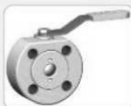
ZAWÓR KULOWY BLOKOWY WK 4ag gwintowane otwory Katalog str. 6,7 Ciśnienie pracy: PN 16-40, Zakres temperatur: od -30°C do +110°C
